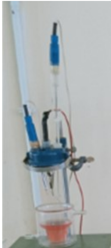
Figure 3.1. Cellule électrochimique utilisée pour l'élaboration des couches minces de Cobalt
