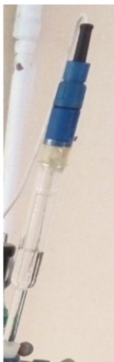
Figure 3. 3- Photographie de l'électrode de référence Ag/AgCl
