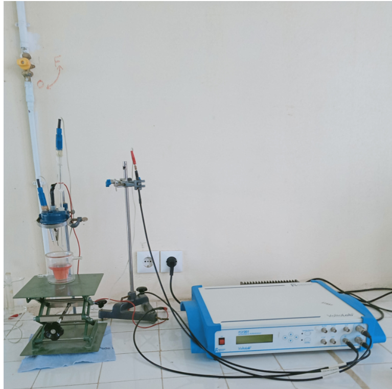
Figure 3.2- Dispositif expérimental utilisé pour l'élaboration des couches minces de Cobalt.
