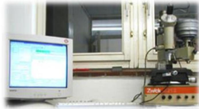
**Figure III.7 :** Microduromètre de type ZWICK.
