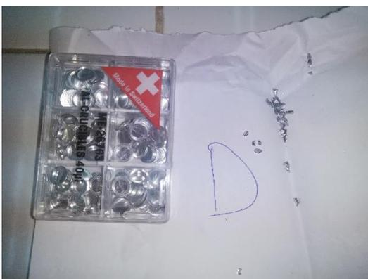
**Figure III.5 :** Creuset en Aluminium avec couvercle.
