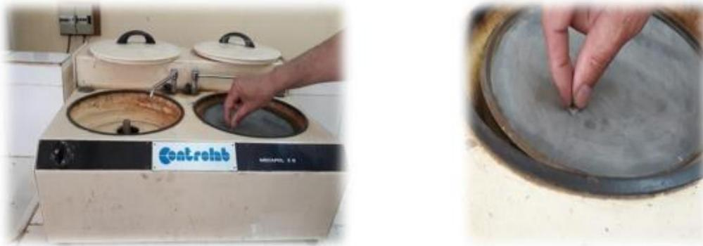
**Figure III.2 :** Polisseuse mécanique utilisé de type MECAPOL 3B
