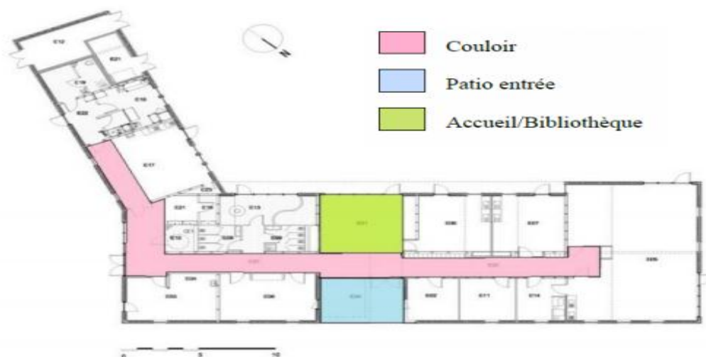
Figure 60 plan RDC du bâtiment avec la circulation
