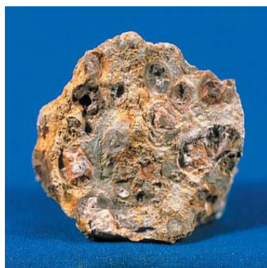
Figure 1.5 : La Bauxite : le minerai le plus utilisé pour obtenir de l'alumine [16].
