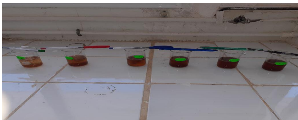
Figure.IV.4 : Echantillon d'acier dans une solution corrosive avec et sans inhibiteur.
