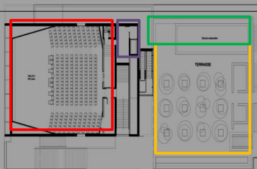
Figure n°12 : plan du 3eme niveau ; Le cinéma est prolongé par une grande terrasse en plein air qui se trouve au-dessus de la fondation de l'édifice commercial. Il est géré par le cinéma et a une capacité de 400
