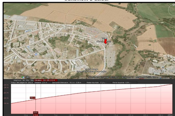
Figure A-101: profile en long du terrain, source : Google earth + traitement d'auteur.
