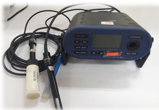
**Figure 11** : Photo du multi-paramètre utilisé (WTW Multi 1970i) (Photo personnelle).
