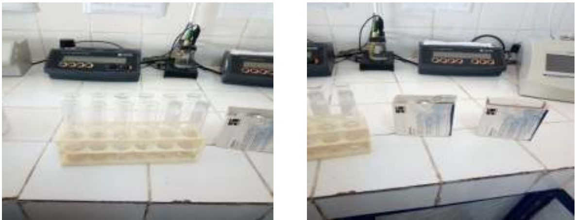
Figure : Test de Chlore par des comprimés DPD 1 et DPD 2
