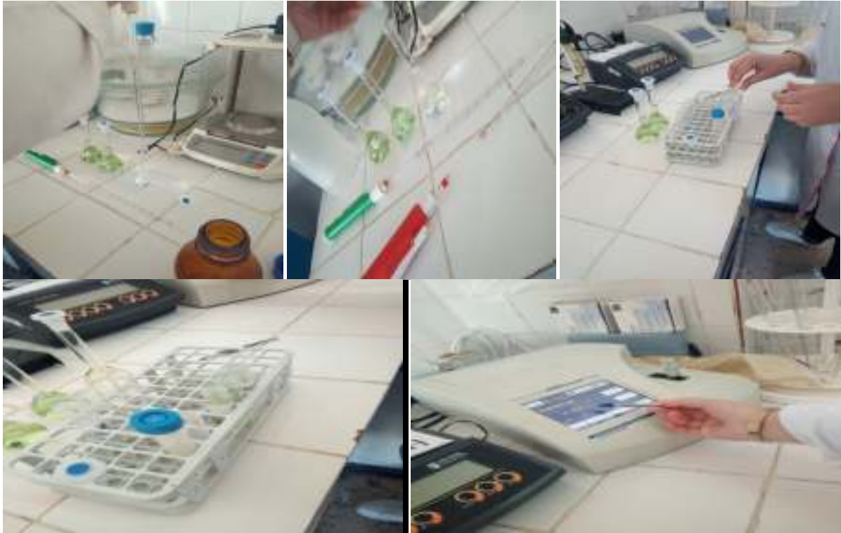
Figure : Mesure de l'azote ammoniacal par Spectrophotomètre
