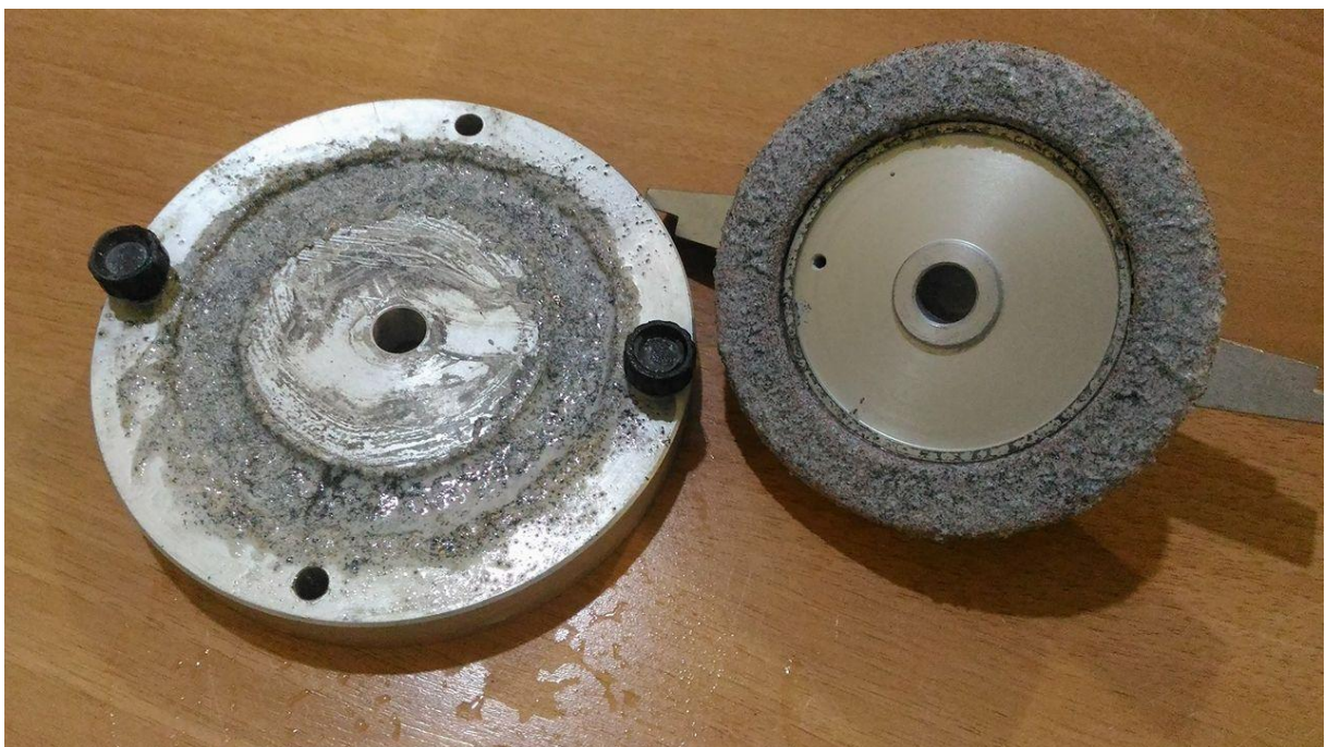
Figure B.5 Photo de l'E4 (PC 15%) dans la boîte d cisaillement annulaire après cisaillement à une contrainte normale de 101,32 (kPa), état saturé
