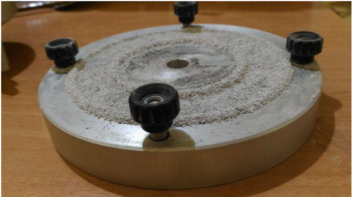
Figure B.4 Vue proche de la surface de rupture après cisaillement de l'E5 sous un contrainte normale donnée.
