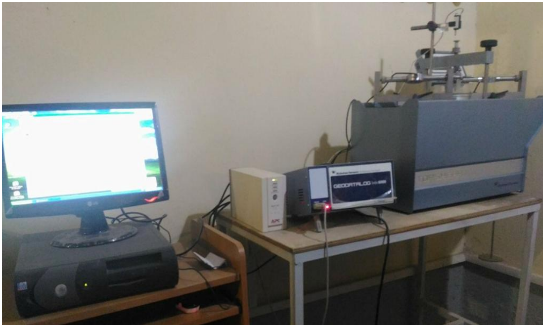
Figure 3.1 Vue générale de l'appareil de cisaillement annulaire de Bromhead.
