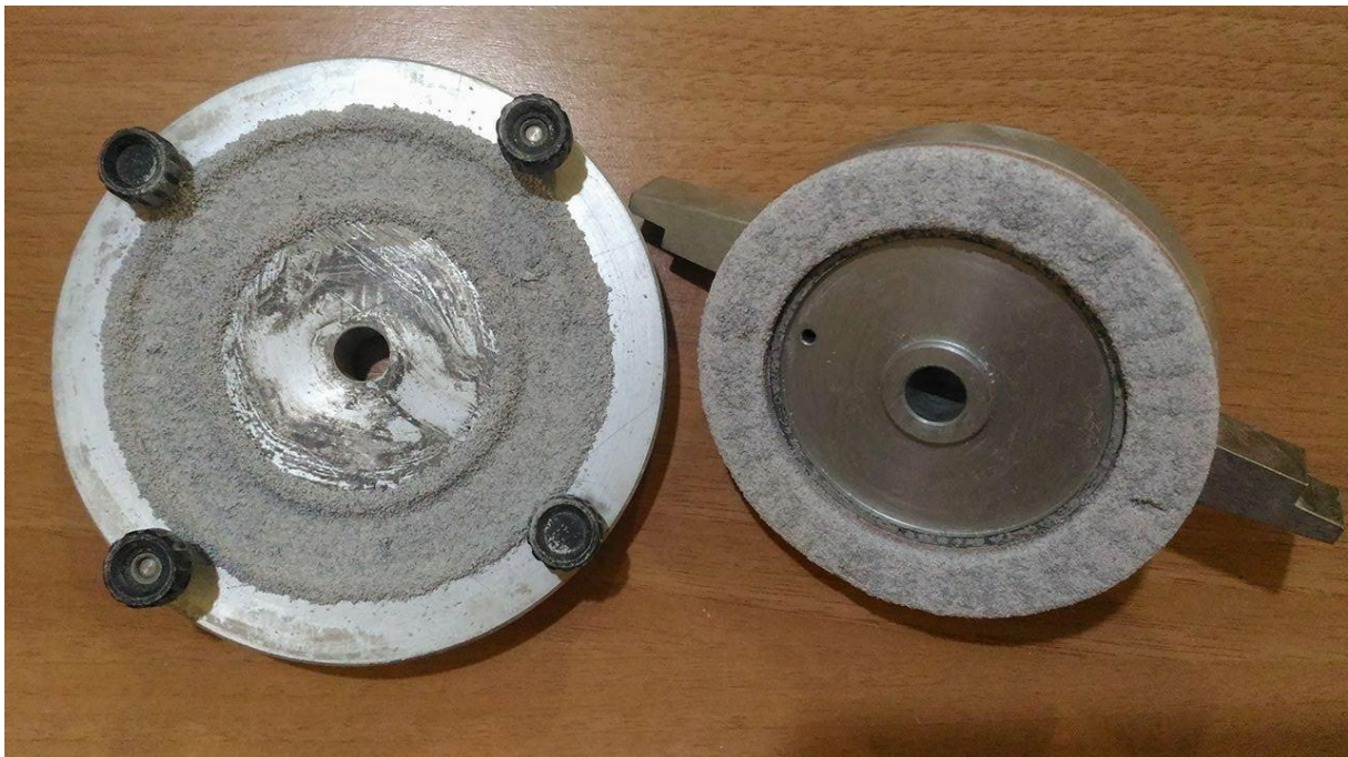
Figure B.3 Photo de l'E5 (PC 20%) dans la boîte d cisaillement annulaire après cisaillement à une contrainte normale de 101,32 (kPa), état non saturé
