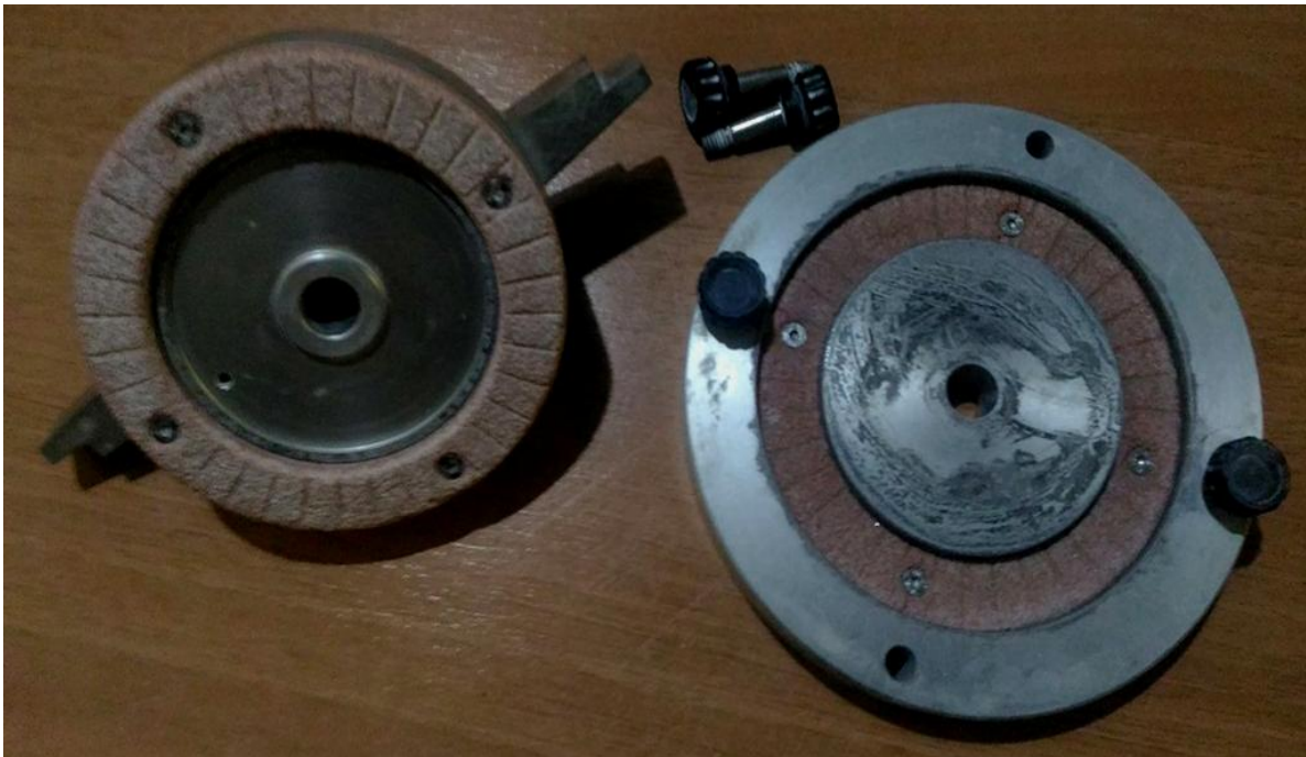
Figure 3.2 les anneaux de confinement (à gauche : plateau supérieur, à droite : plateau inférieur)
