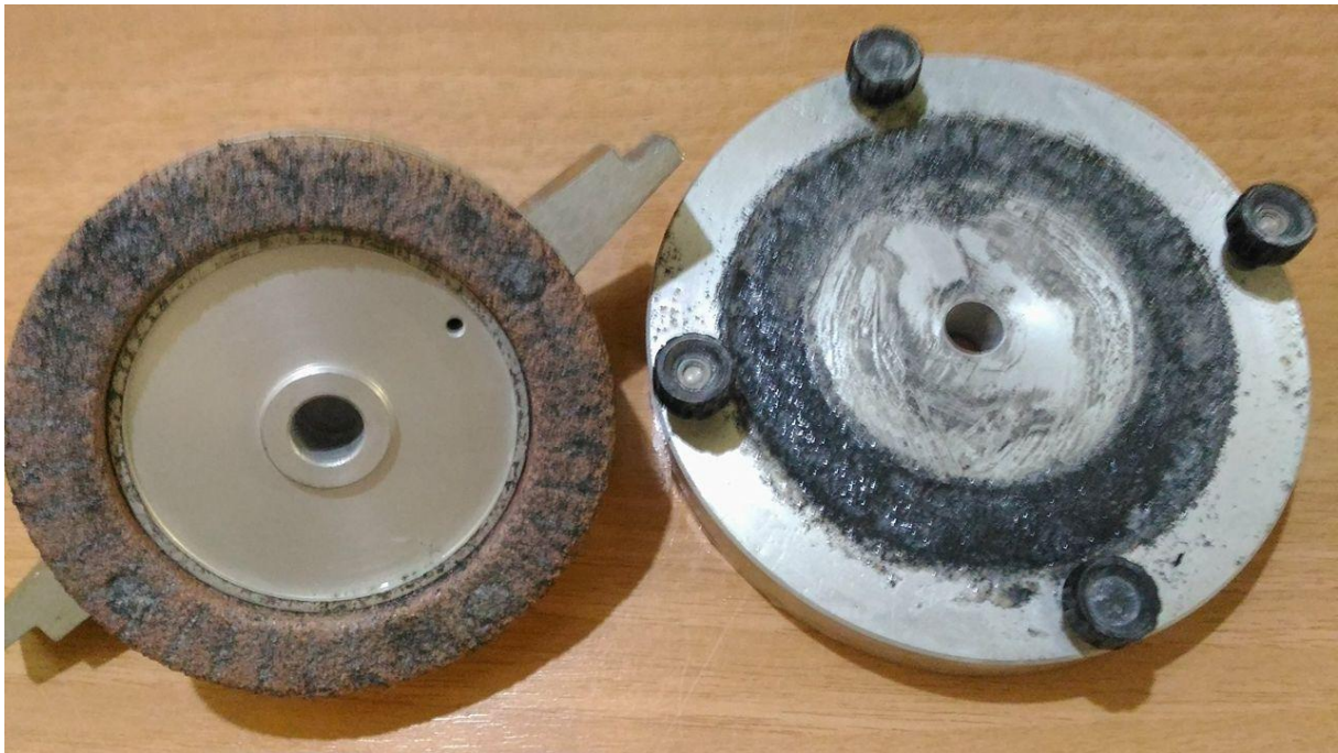
Figure B.6 Photo de l'E5 (PC 20%) dans la boîte d cisaillement annulaire après cisaillement à une contrainte normale de 202,65 (kPa), état saturé
