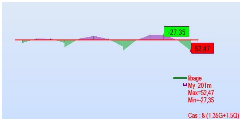
Figure VII.9. Exemple des diagrammes des moments agissants aux niveaux des nervures.
