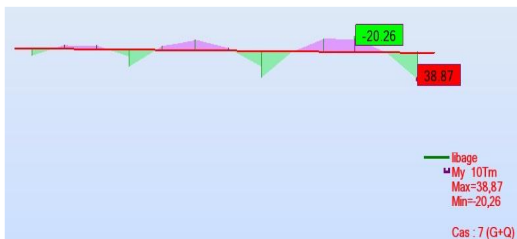
Figure VII.10. Exemple des diagrammes des moments agissants aux niveaux des nervures(ELS)
