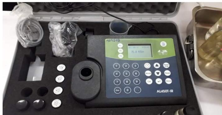
**Figure 17:** Le turbidimètre
