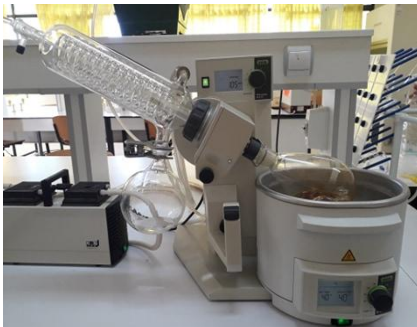
Figure 06: Procédé d'évaporation avec un évaporateur rotatif.
