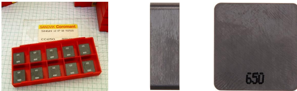
Figure II.3 Plaquettes CC650 utilisée [34]
