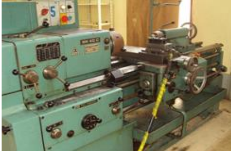
Figure II.1 Tour à charioté et à fileter modèle SN40[32]
