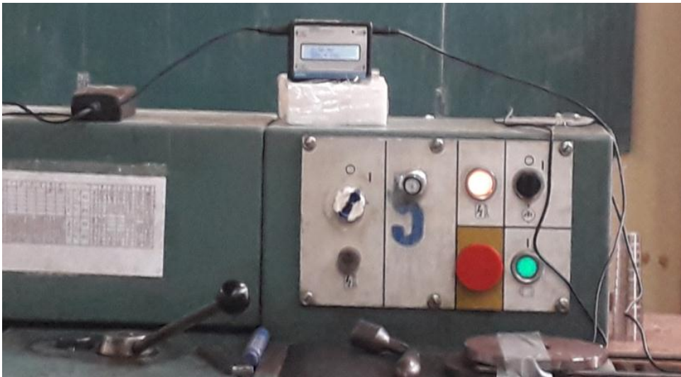
Fig.II.2. Tachymètre pour le contrôle de la fréquence de rotation
