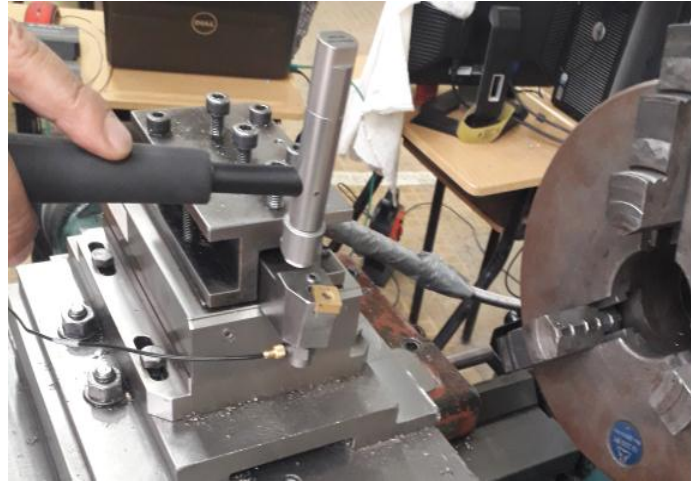
Fig. II.4 Test modal de l'outil de coupe
