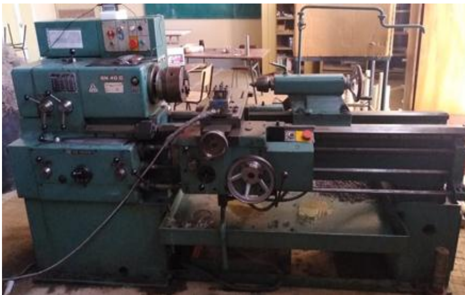
Fig. II.1. Tour à charioter et à fileter modèle SN40 équipé d'un variateur de vitesses
