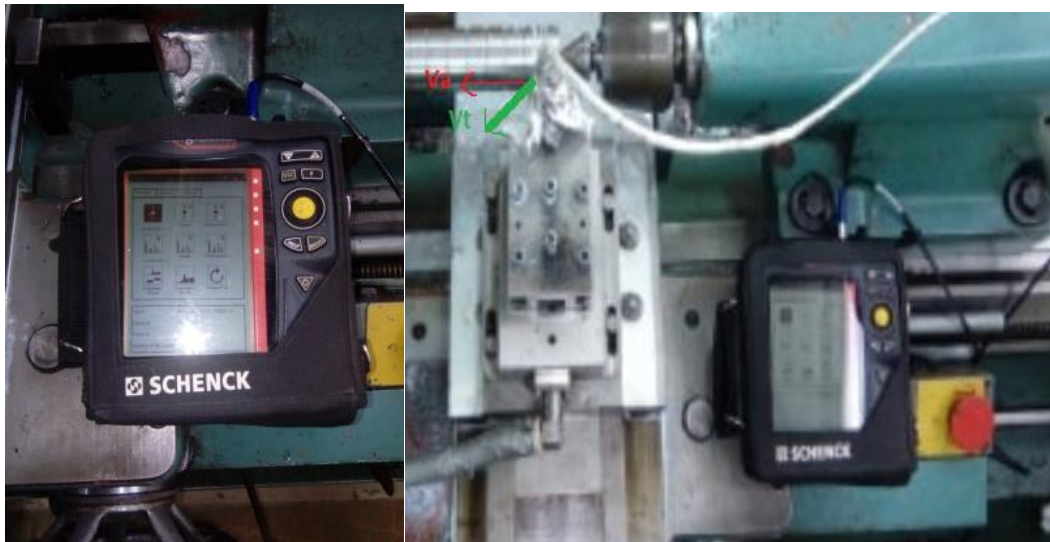
Figure II.8 : Positionnement de l'accéléromètre sur le porte outil
