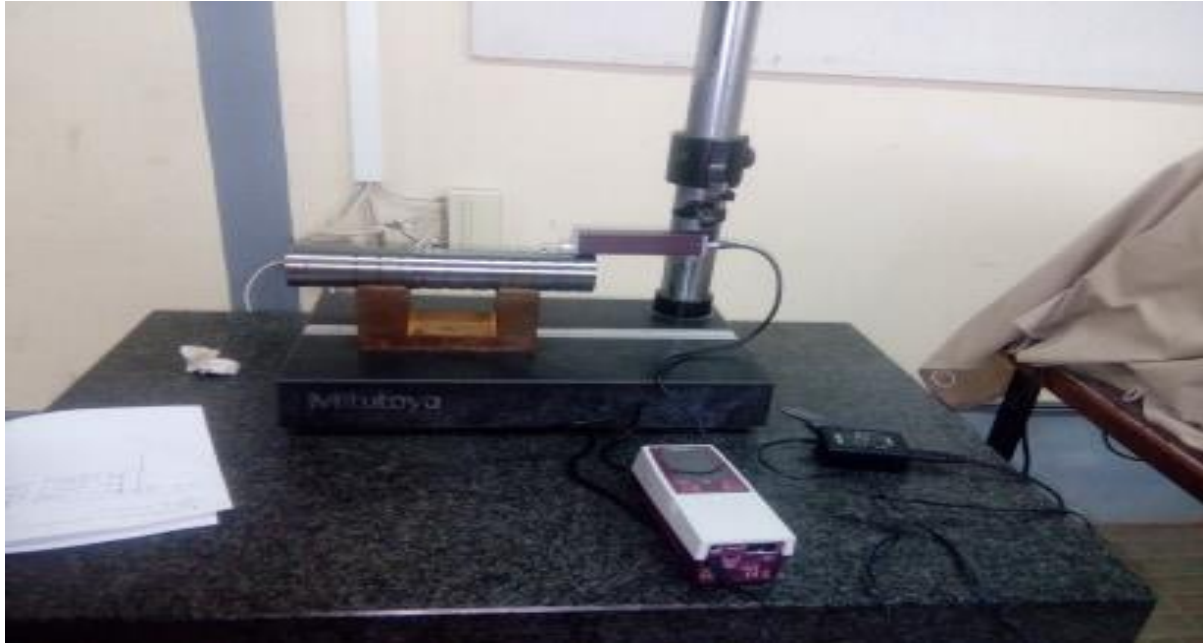
Figure II.7 : Mesure de rugosité avec démontage de la pièce
