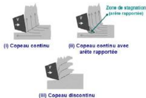
Figure 1.3 – Classification d'Ernst des différents types de copeaux [11]
