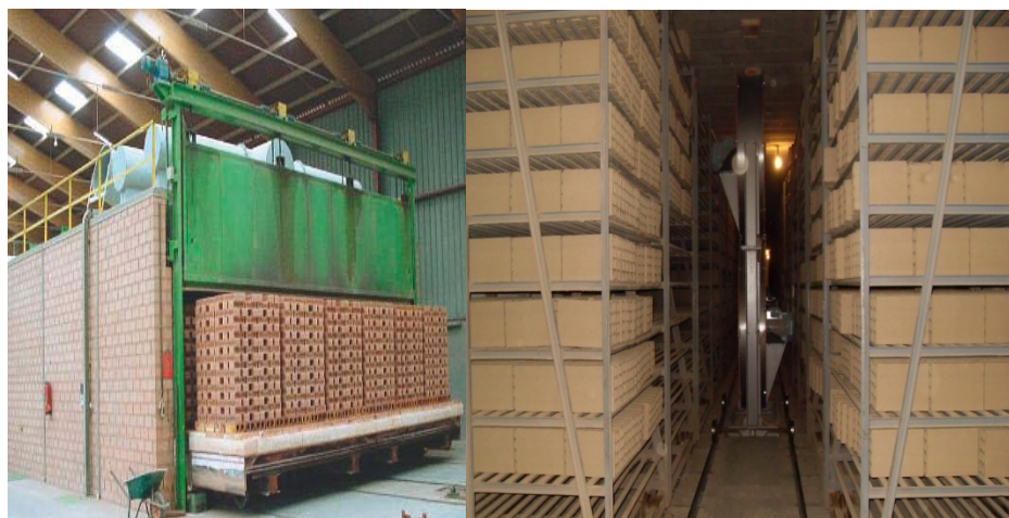
Figure 1.10: séchage de briques [19]
