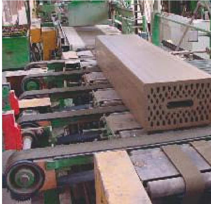
Figure 1.9: Façonnage de la brique [19]
