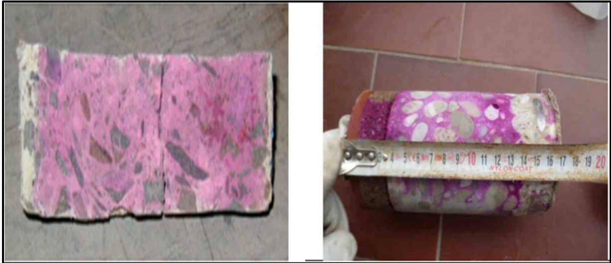
Figure II-7 : phénomène de la carbonatation.
