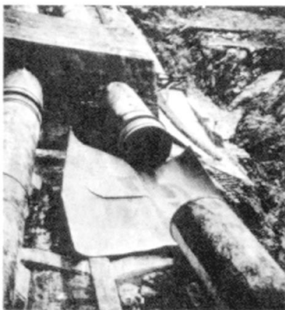
Figure (1.1) : Vue d'une conduite forcée éclatée de la centrale électrique d'Oigawa, du Japon [9]
