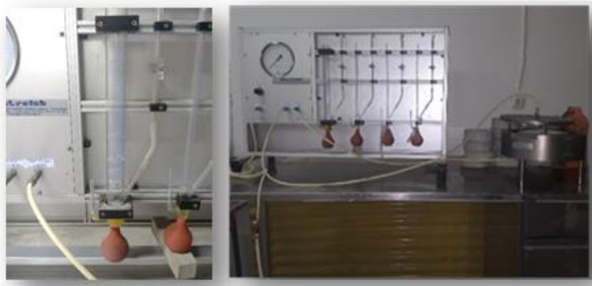
Figure V.15 Dispositif utilisée pour le calcul de la perméabilité à l'air (compte-bulles)
