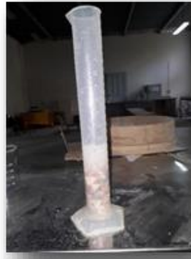
Figure IV.9. Mesure de la masse volumique absolue du gravier.
