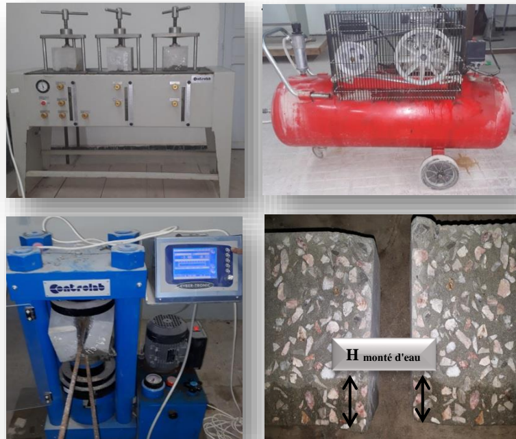
Figure V.17 Dispositif utilisée pour le calcul de la pénétration de l'eau.
