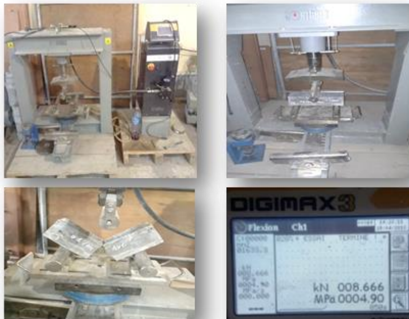
Figure V.12 Essai de flexion réalisé avec ses étapes.
