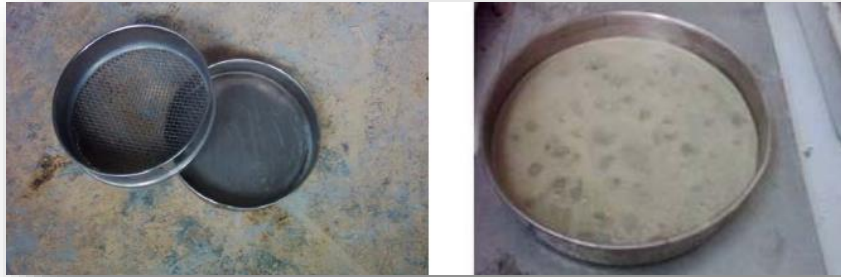
Figure V.8 Essai de stabilité au tamis.
