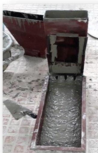
Figure V.7. Essai De boîte en L.
