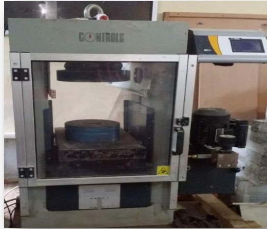
Figure II.12. Mesure de la résistance à la compression.
