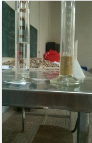
Figure IV.3 Mesure de la compacité du sable.
