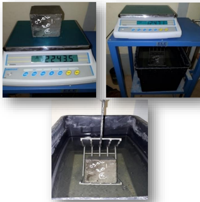
Figure V.14 Essai de porosité.
