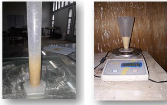
Figure IV.2 Mesure de la masse volumique absolue du sable.
