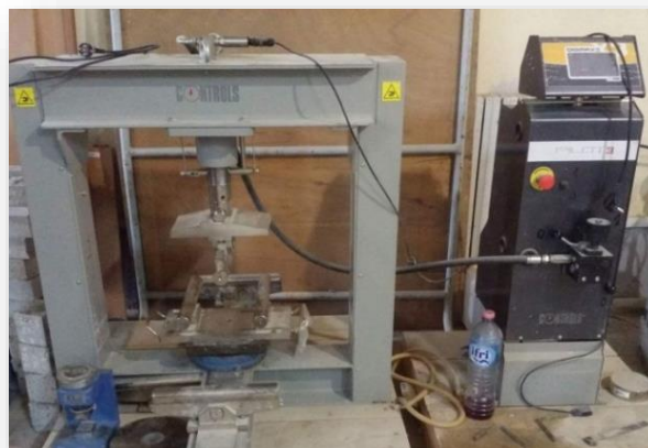
Figure II.13. Mesure de la résistance à la traction par flexion.
