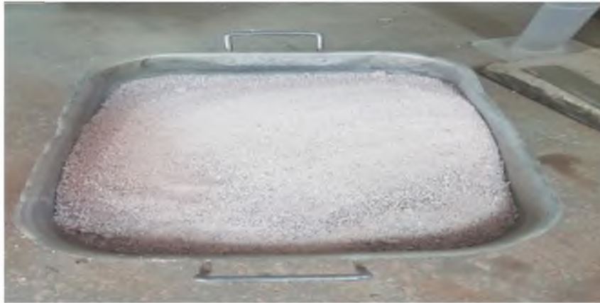
Photo 5.6 L’essai Proctor pour sol A avec la poudre du marbre (Laboratoire (LTPE. Annaba)).
