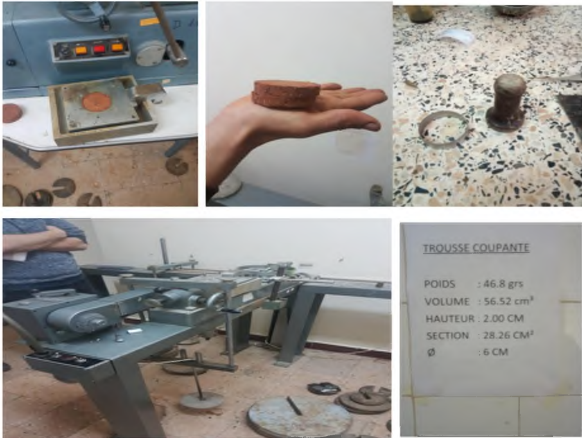
Photo 5.13 Essai de la boîte de cisaillement au laboratoire (LTPE-Annaba).
