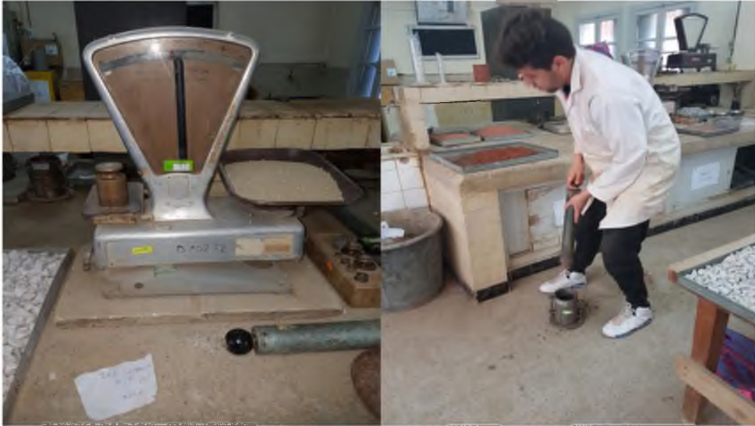
Photo 5.2 Essais de compactage dans laboratoire (LTPE .Annaba).
