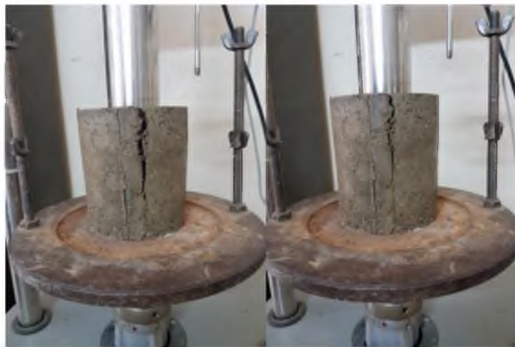
Photo 5.11 La déformation de Sol A avec Le Marbre après la compression laboratoire (LTPE. Annaba).
