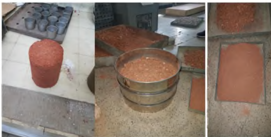
Photo 5.7 L'essai Proctor pour sol B sans additives
