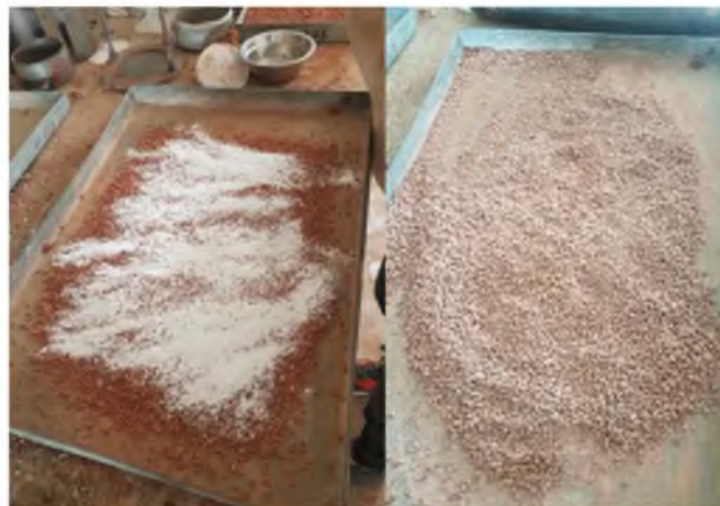
Photo 5.8 L'essai Proctor pour sol B avec la chaux (laboratoire (LTPE. Annaba)).
