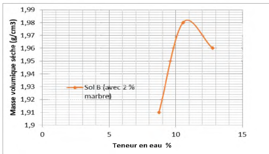
Figure 5.15 Courbe de compactage (Essai Proctor normal) pour sol B (avec 2% en poudre du marbre).
