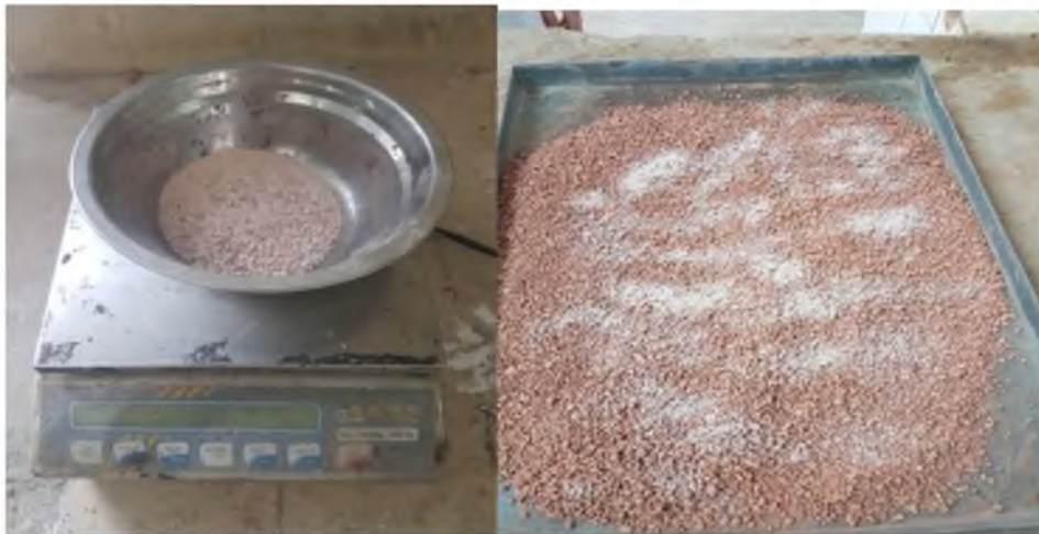
Photo 5.9 l’essai proctor pour sol B avec Le Marbre_ laboratoire (LTPE. Annaba)
