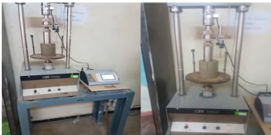
Photo 5.10 : Les machines utilisées pour l'essai de la Compression simple_ laboratoire (LTPE. Annaba)
