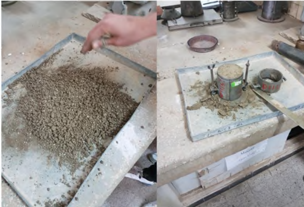
Photo 5.3 Essais de compactage du sol A dans laboratoire (LTPE .Annaba).
