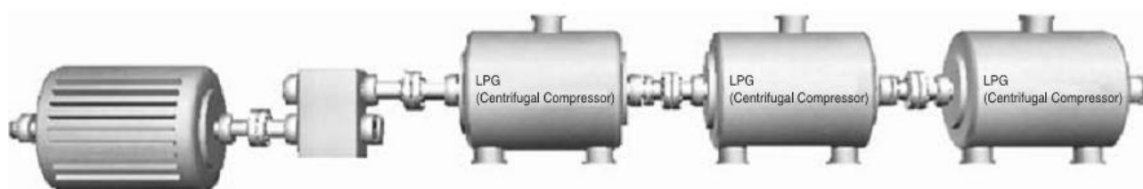
Figure 1.1 : Turbomachines reliées par des accouplements d'arbres [3] .
