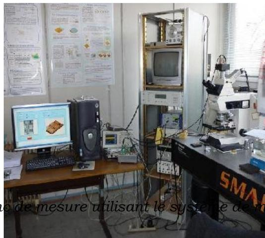
**Fig. I-12** : Banc de mesure utilisant le système de microscopie CAM 4D
