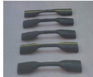
b)Eprouvettes d'essais Figure II-
