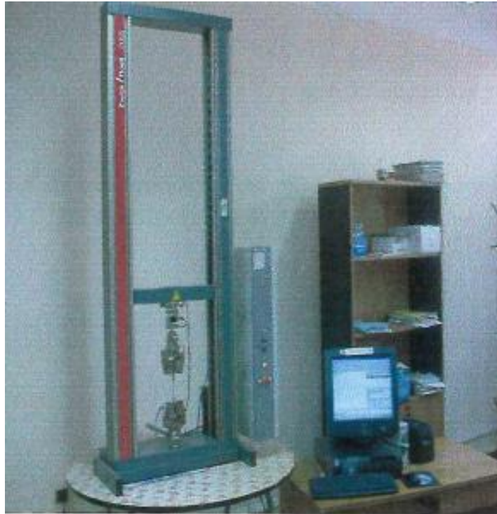
Figure II- 3:Machine d'essai universelle Type Zwick Z005
