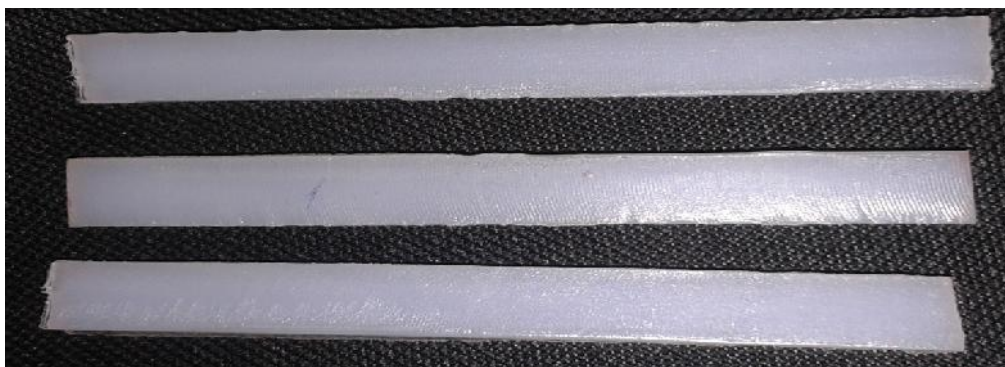
Figure II.3. Préparation des éprouvettes de choc sur une machine de fraisage verticale.
