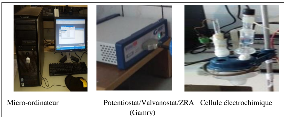
Figure II.3 : Dispositif expérimental utilisé pour les essais des impédances électrochimiques.
