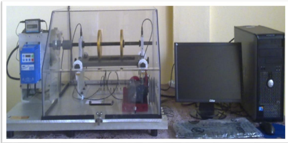
Figure 2. Photo de simulateur des défauts de machines. Ordinateur équipé de logiciel VibraQuest.
