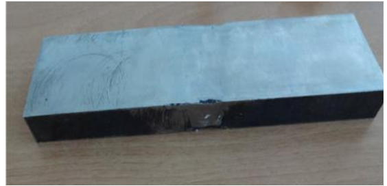
Photo IV.10 : La pièce après le soudage
