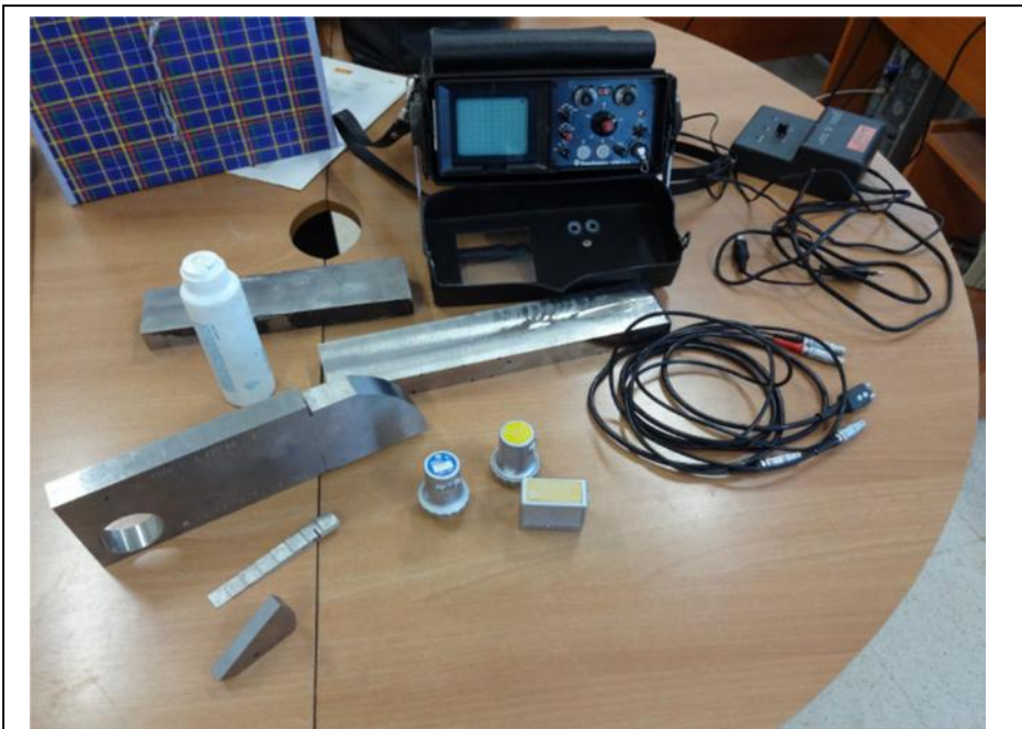
Photo .IV.1 : Dispositif de contrôle par ultrasons (labo. LMS)
