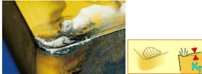
**Figure I.10** Usure chimique
