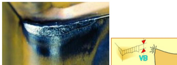
**Figure I.9** *Usure par abrasion*
