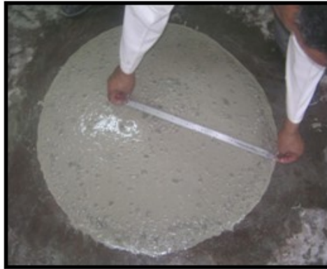
Figure II.4: Exemple de mesure de l'étalement des BAP au cône d'Abram's.
