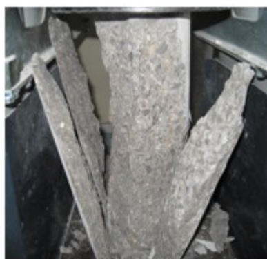
Figure II.19: Processus de rupture des éprouvettes en compression.
