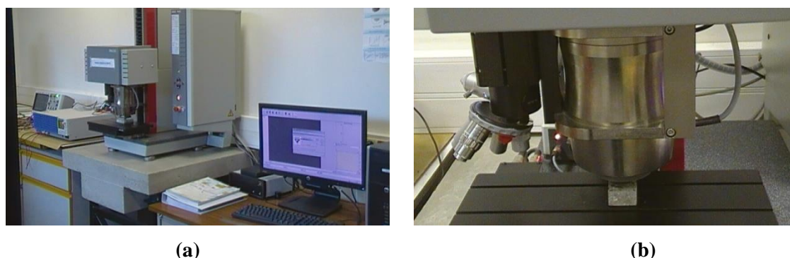
Figure III.21: (a) Vue générale du macro indenteur Zwick Rowell 2,50KN et (b) zoom sur les deux cellules d'observation et d'indentation.
