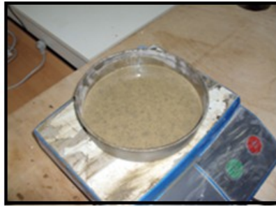
Figure II.6: Mesure de la stabilité des BAP.
