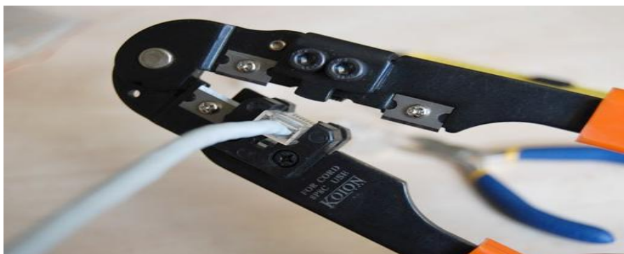
Figure I.4: Sertissage d'un câble RJ-45
