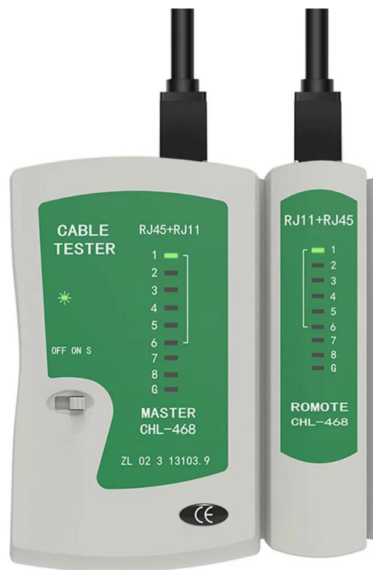
Figure I.5 : Testeur de câble RJ-45
