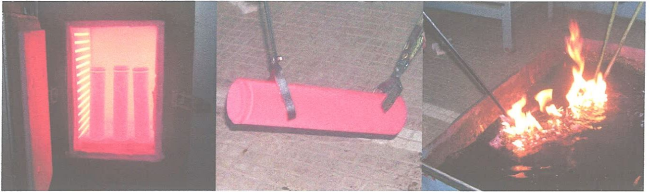
(a) Chauffage des éprouvettes (b) Transport de la pièce (c) Trempe à l'huile
