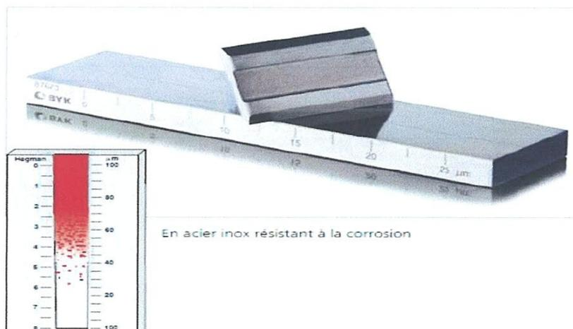
Figure VI.2 : Mesure de la finesse des grains
