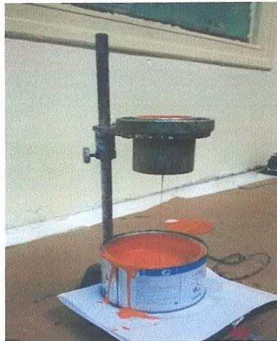
Figure VI.4 : Viscosimètre « coupe Ford »
