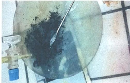
**Figure VI.10: Prise d'huile de l'échantillon**
