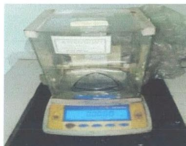
Figure V.4 : Balance de précision
