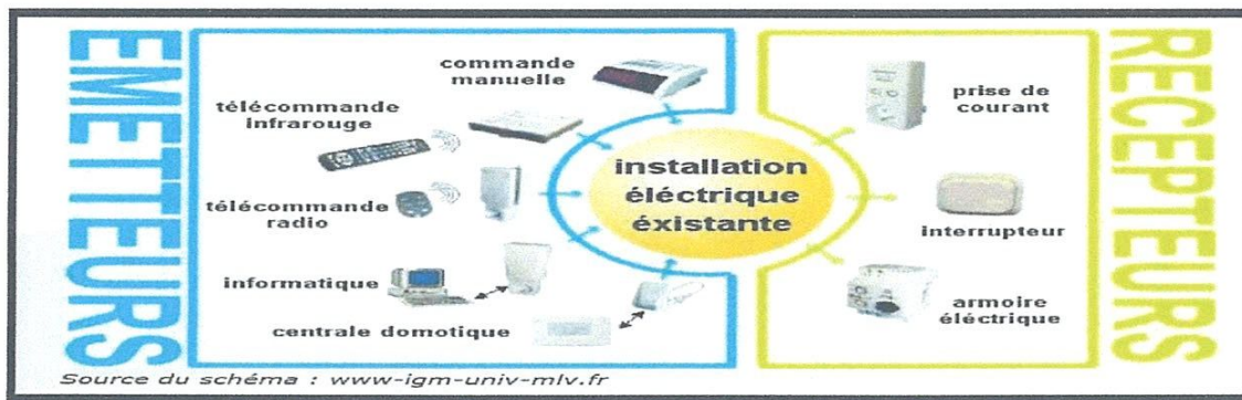
Figure 4: L'installation électrique traditionnelle (source : Réussir son installation domotique et multimédia François-Xavier Jeuland)
