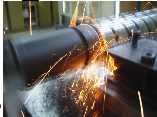
Opération de tournage dur avec dynamomètre type 9257B
