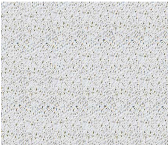
Figure II.1: Structure du béton cellulaire (échelle 1/1).
