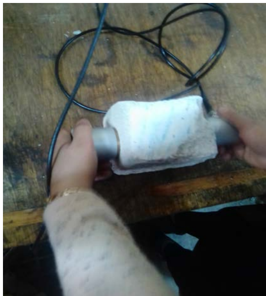
Figure V.15: Essai à l'ultrason au laboratoire de recherche LGCH* sur un échantillon de mur en béton cellulaire
