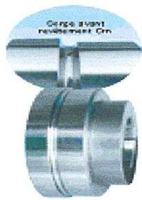
Formeur tube automobile ø gorge ± 0.01, Position ± 0.01, Ra 0.2, matière Z180 traité 61-62 Hrc
