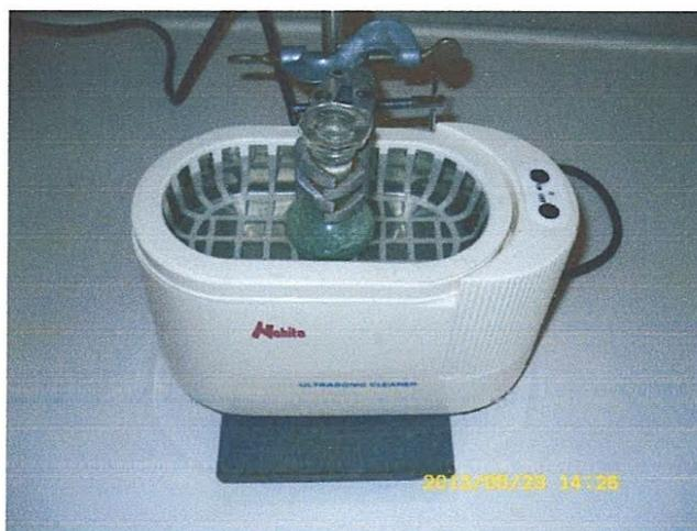
Figure V.38 :Bac à ultrason 500 mL
