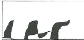
Figure. 7: Forme de la corrosion sélective.
