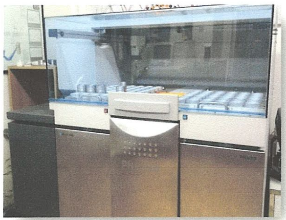
Figure 10 : Spectrophotomètre PANalytical Magix PRO à Fluorescence X
