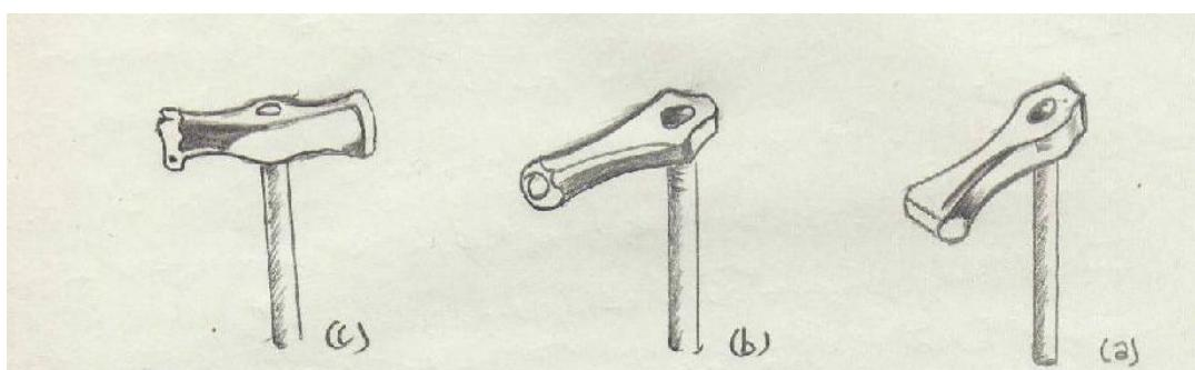
الشكل رقم 03: رسم يوضح أشكال المطرقات: (C) a planer- (B) a emboutir - (A) a rétreindre: (امقران نبيل)
