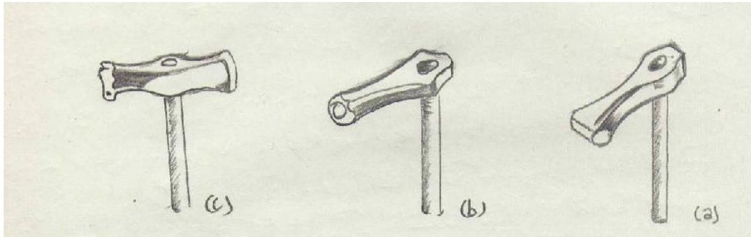
الشكل رقم 03: رسم يوضح أشكال المطرقات: (A) a rétreindre - (B) a emboutir - (C) a planer:
