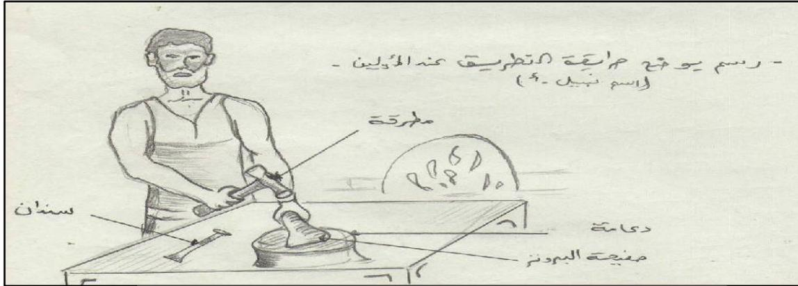
الشكل رقم 02: رسم توضيحي لعملية الطرق (امقران نبيل)
