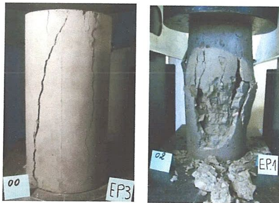
Figure 5. Modes de rupture et d'endommagement des éprouvettes de béton témoin (béton_00_EP 3) et (béton_02_Ep 1).
