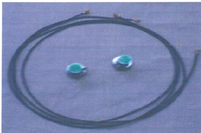
Figure III.7: Accéléromètre d'acquisition des signaux de type piézo-électrique «EDNEVCO Model 2215 E»
