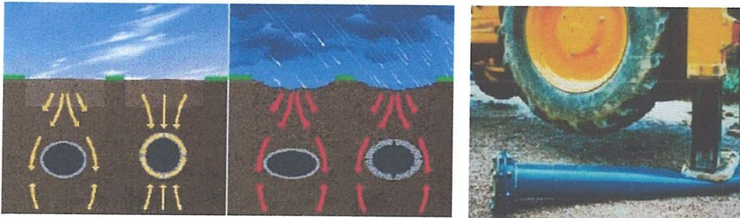
Figure.10 Elasticité et flexibilité des tubes en PEHD. [10]
