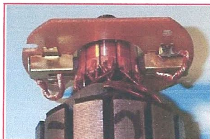
Fig. (I.12) : Balais montés sur collecteur. [3] ; [1].
