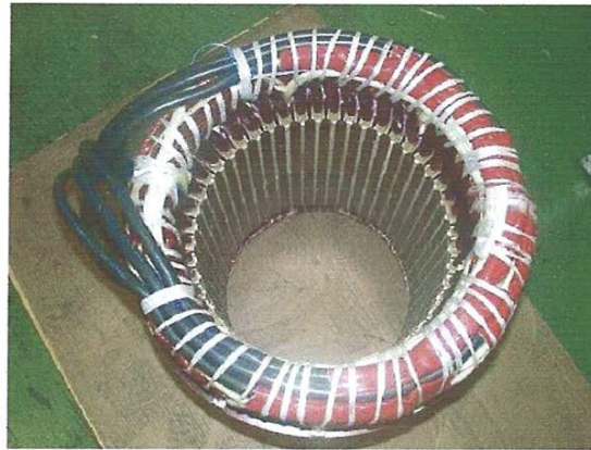
Figure I.8: stator d'une machine à flux radial [1]
