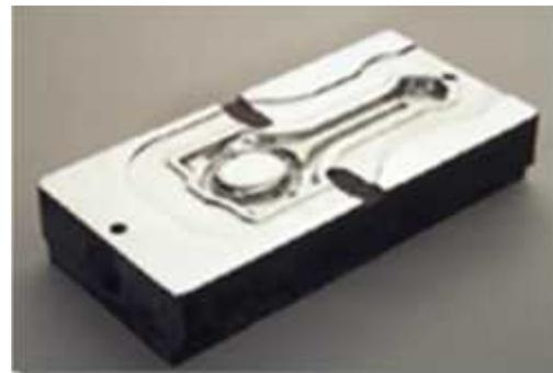
**Fig. I.2.** Exemple de fabrication par UGV à Commande numérique des matrices de forge pour bielle en acier traité [10].
