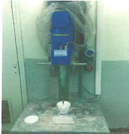
**Figure (IV-8) : Broyeur à haute vitesse d'agitation**
