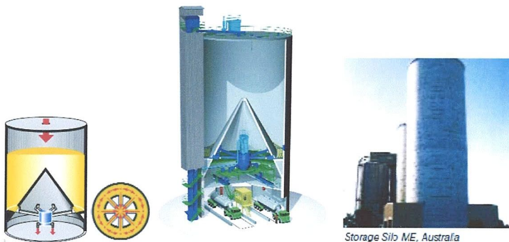
Figure 21 : Fonctionnement d'un silo muni d'un système multi-extraction
