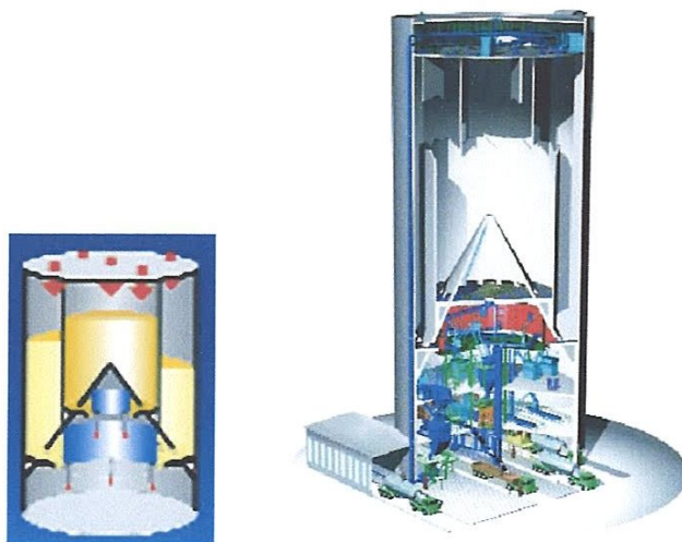
Figure 23 : Schémas d'un silo multi-stockage
