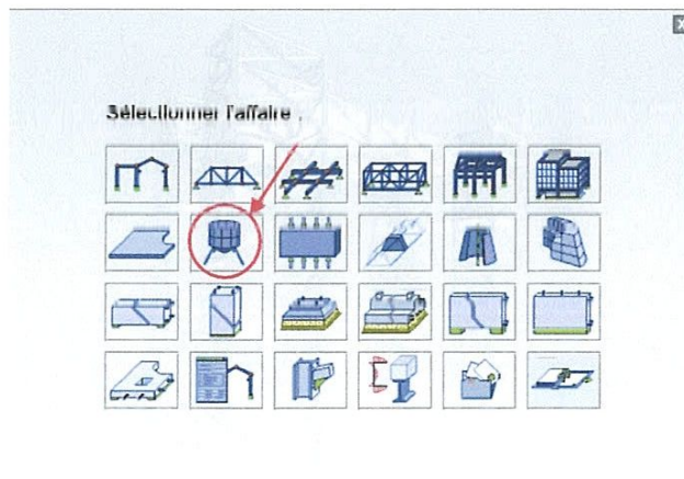
Figure 28 : Choix du type de structure sur Robot
