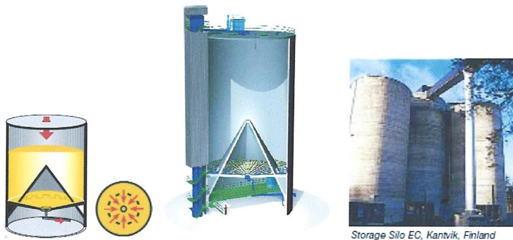
Figure 17 : Fonctionnement d'un silo à chambre d'expansion simple
