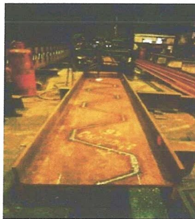
Fig.1.23. Découpage numérique de poutres alvéolaires.
